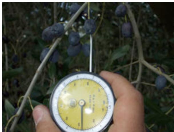
Figura 7 – Misurazione forza di distacco
